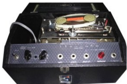
La máquina echoplex original, basada en una cinta magnética en bucle
